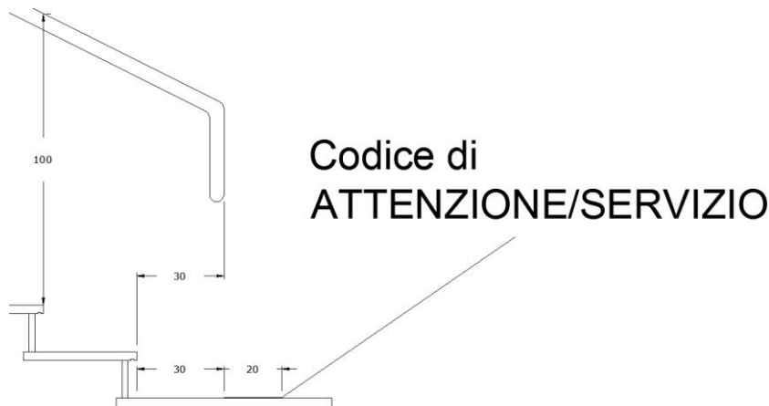
Disegno n. 9e – Corrimano in corrispondenza della base di una rampa di scale (si noti come eseguire il prolungamento e la piega verso il basso).
